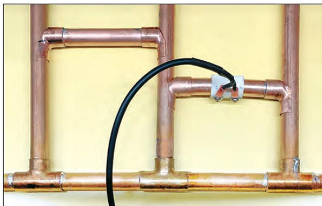
Fot. 4.4.5. Szczegóły zasilania anteny
