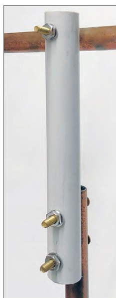
Fot. 4.4.7. Szczegóły umocowania na maszcie, wspornik po przeciwnej stronie anteny
